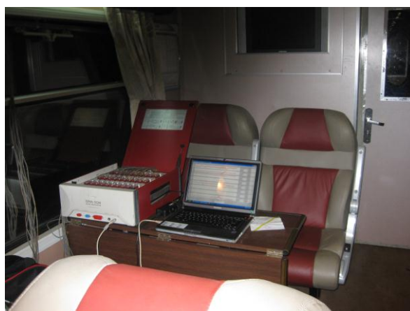
Hình 3. Thiết bị đo ứng suất động DRA-30A trên toa xe khách Rumani A31351
